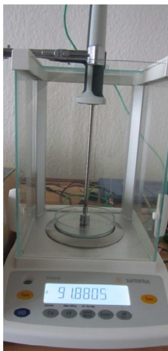
Obrázek 36 Správná orientace při vážení sondy povrchového teploměru
