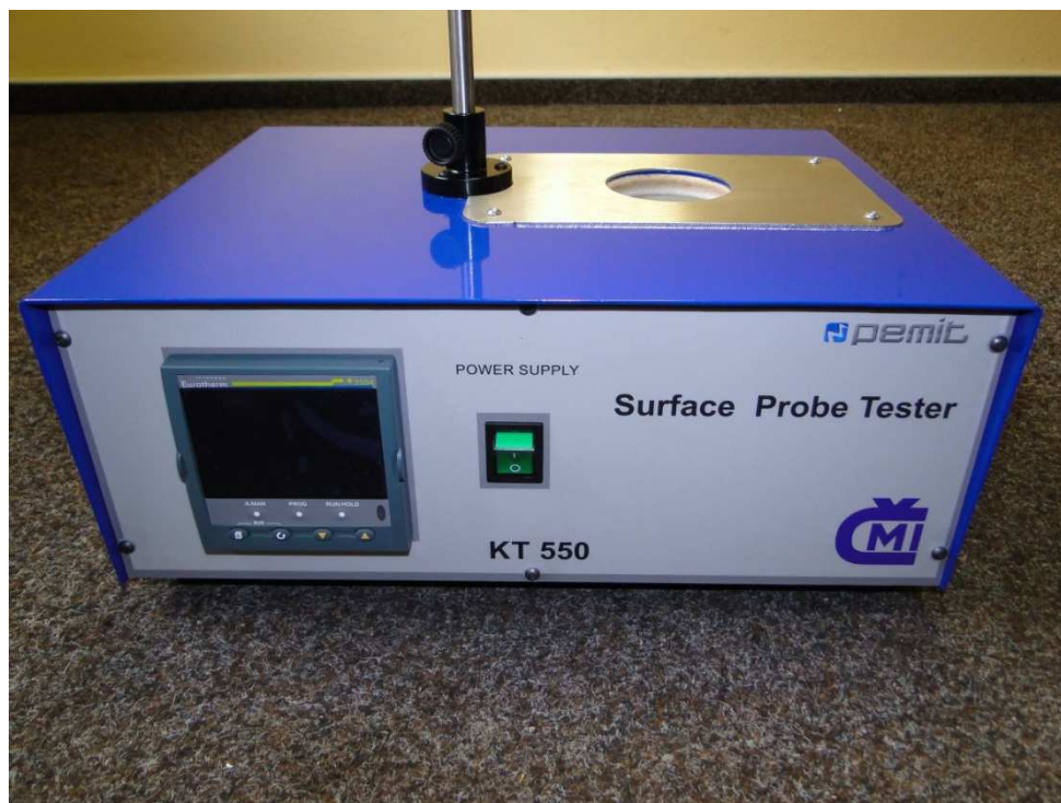
Obrázek 27 Kalibrátor povrchové teploty s Al povrchem, ČMI KT550, použitý ve výše popsaném měření
